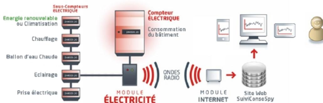
Le module Tableau Electrique est un boîtier de surveillance et de suivi s'installant dans le tableau électrique. Respectant la norme RT2012, la consommation de vos différents postes énergétique ( chauffage, ballon d'eau chaude, climatisation, prises électriques, éclairage ) ne seront plus un mystère pour vous.
